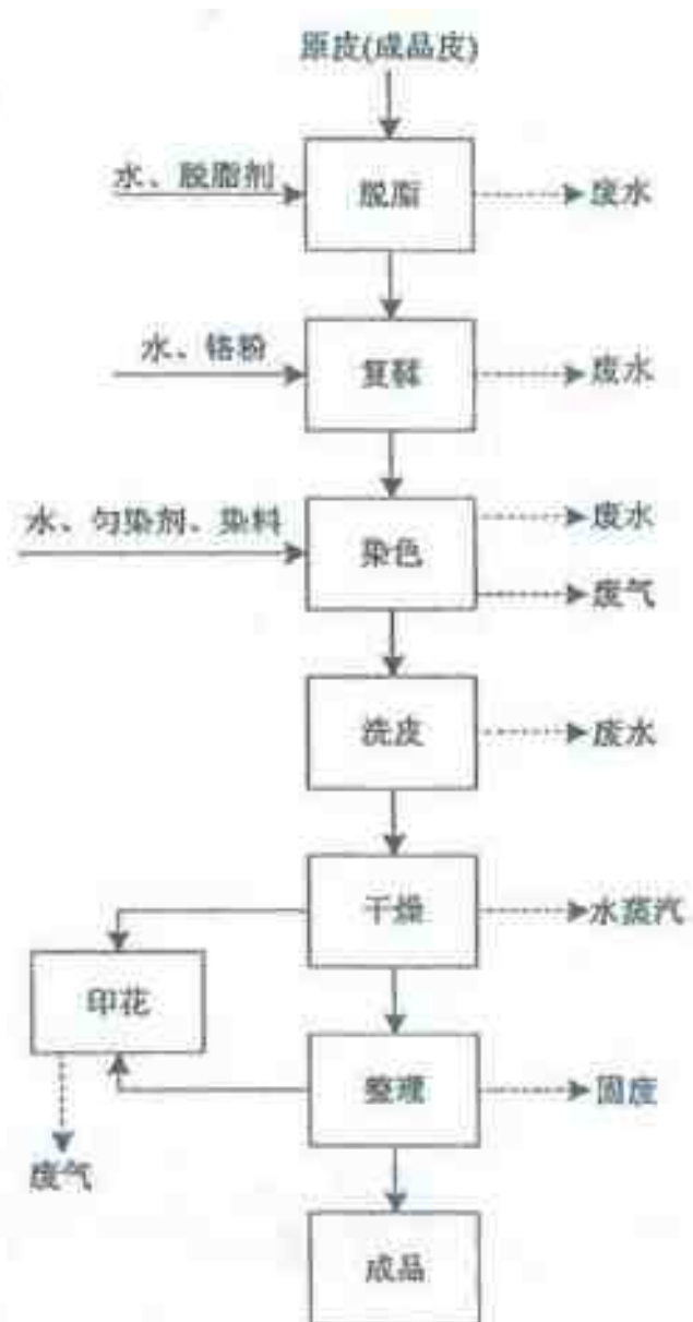
图 3-7 毛皮鞣制（细杂皮）生产工艺流程图
