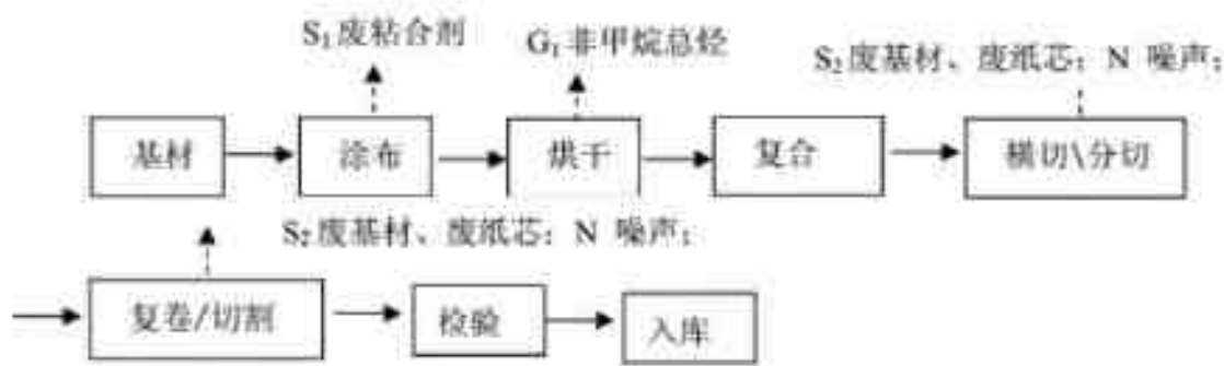
图 3-18 医用胶布生产工艺流程图
